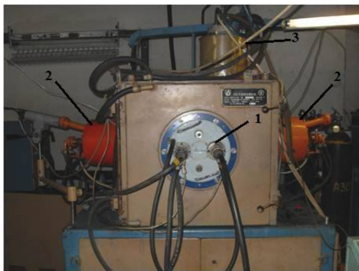
Рис. 1. Комбинированная установка «Композит-3»: 1 - дуомагнетрон с двумя распыляемыми мишенями, 2 – электродуговые испарители, 3- газовый плазмодогенератор
