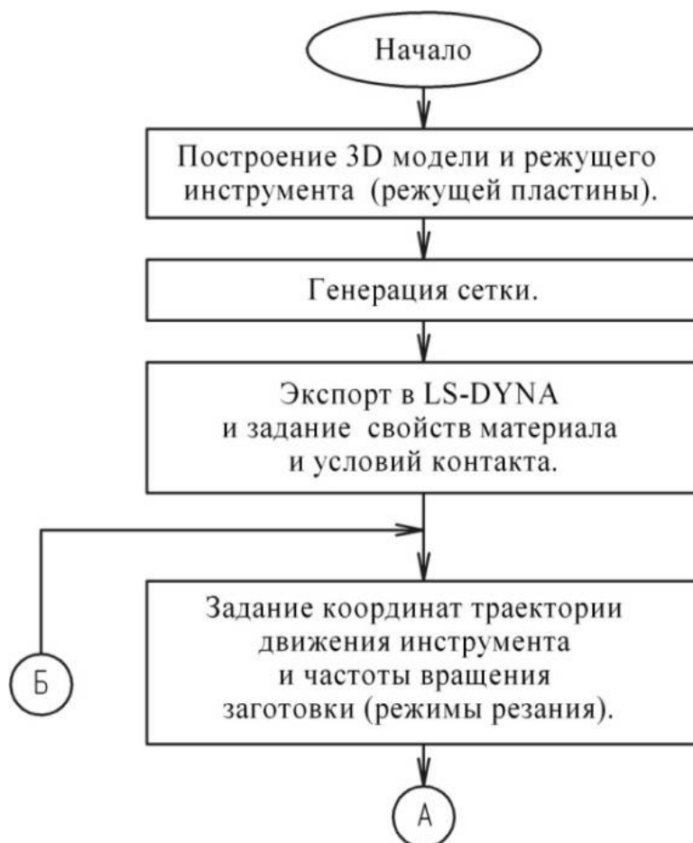
Рис. 2. Алгоритм прогнозирования отклонений точности формы отверстий тонкостенных корпусных деталей.
