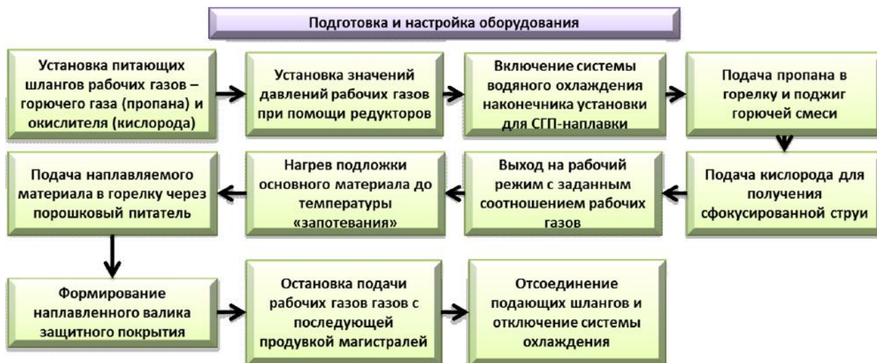
Рис. 5. Алгоритм подготовки и настройки оборудования
