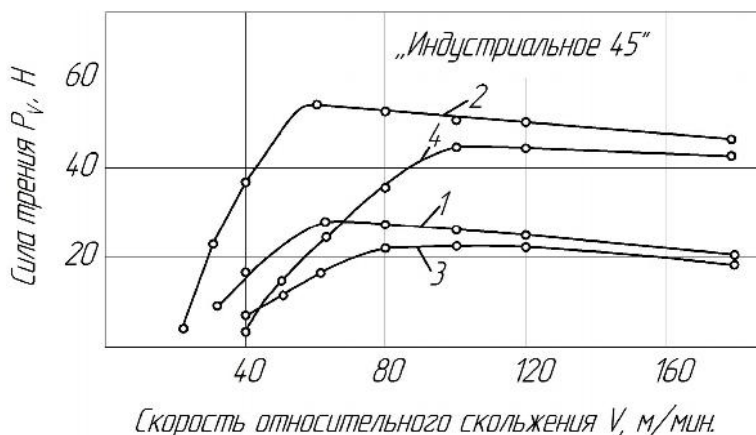
Рис. 2. Зависимость силы трения от двойной амплитуды колебаний (2А) и статической нагрузки ( P_{ст} ) и при различных скоростях обработки: 1 – P_{ст} = 200 Н; 2А = 20 мкм; 2 – P_{ст} = 400 Н; 2А = 20 мкм; 3 – P_{ст} = 200 Н; 2А = 60 мкм; 4 – P_{ст} = 400 Н; 2А = 60 мкм
