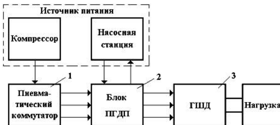
Рис. 1. Структурная схема гидравлического шагового привода
