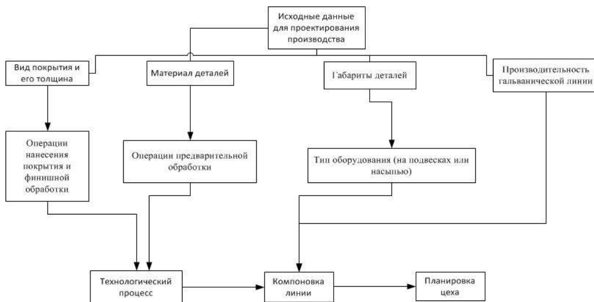
Рис. 1. Схема проектирования гальванического производства
