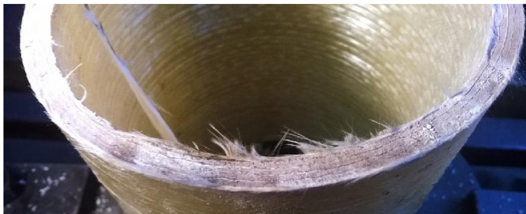
Рис. 2. Расслоение, прижоги обработанной поверхности
