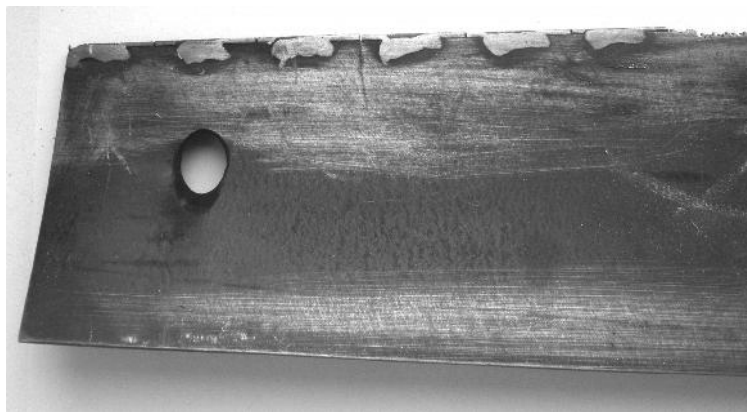
Рис. 1. Внешний вид лопатки с трещиной между защитных пластин
