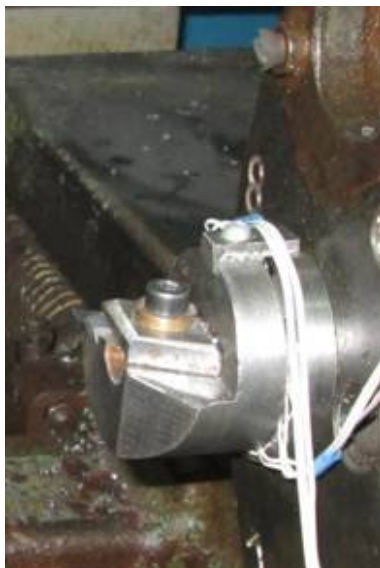
Рис. 2. Сборная конструкция инструментальной оснастки
